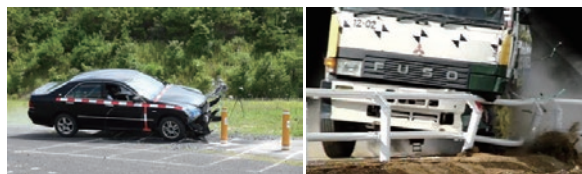
実車衝突試験による性能検証の様子
