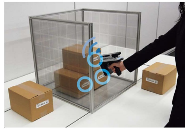
読み取り対象の電子タグだけを正確に読み取り
