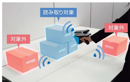
スキャナの電波で読み取り対象物の電子タグを読み取る
