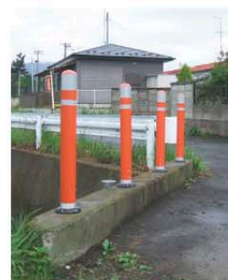
人や自転車の接触の際も適度に変形して衝撃をやわらげ、また容易に元に戻ります。
