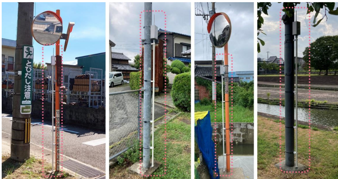
久留米市に設置している IoT 浸水深センサ（一例）
