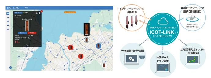
本サービスは、各種 IoT センサーや IoT 表示デバイス(LED 表示板など)から得られる情報を集約・解析し、製品やシステムの一括遠隔監視や、計測値と連動した遠隔制御を可能にするものです。これにより、災害時の道路管理・監視業務の省人・省力化が図れ、防災・減災への貢献が期待されます。
