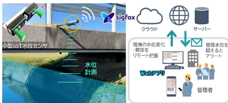
中小河川向け簡易水位センサ「小型 IoT 水位センサ」
