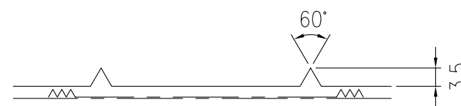
反射体突起部詳細図 S=1/1
