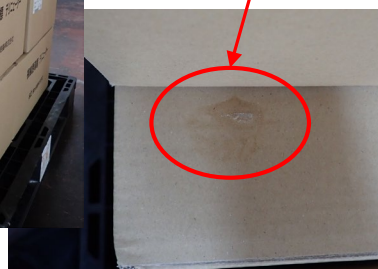
仕様変更後の梱包形態 水溶性接着剤で荷崩れ防止
