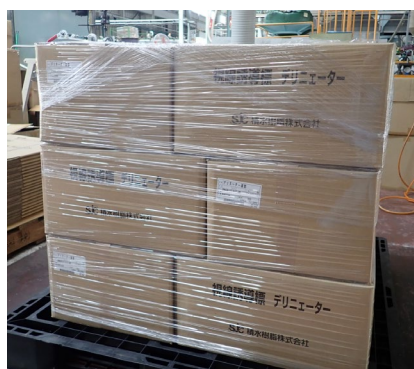
従来の梱包形態 ストレッチフィルムで荷崩れ防止
