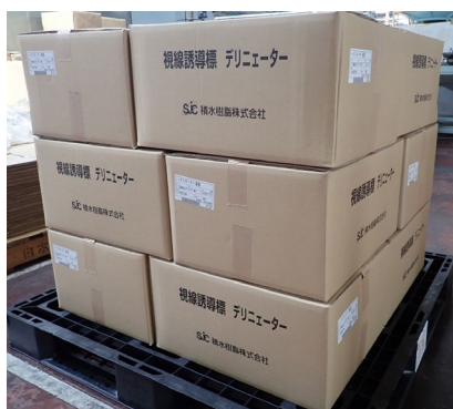
仕様変更後の梱包形態 水溶性接着剤で荷崩れ防止
