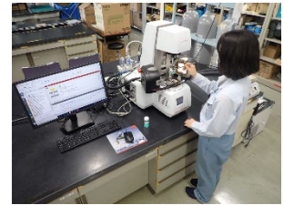
レオメータによる粘度の評価
