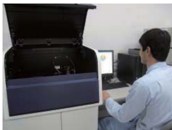
新型分光光度計による日射反射率測定
