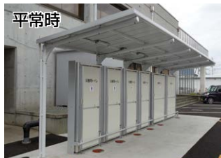
災害対応トイレ付シェルター (自転車置場)
