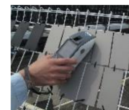
携帯型測色・光沢計による塗装板の耐候劣化評価
