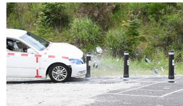
実車衝突による性能確認試験
