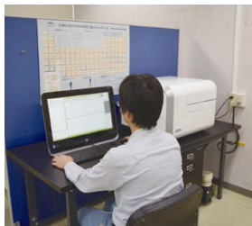
蛍光X線分析装置によるRoHS分析の様子
